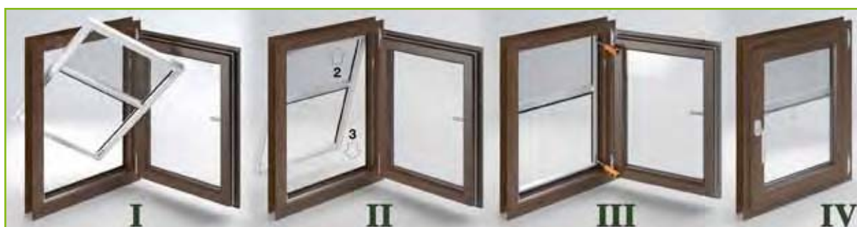
I. Inserire il telaio attraverso il serramento - II. Innestare i ferri a "Z" più lunghi in alto, poi quelli in basso - III. Fissare i ferri con le viti. - IV. FATTO!
